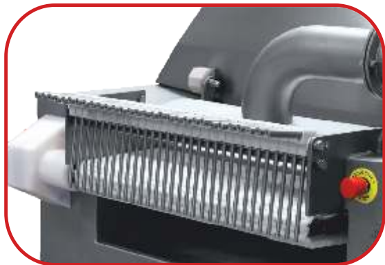
уникальная система устранения чрезмерного кол-ва рассола с поверхности инъектируемого сырья
